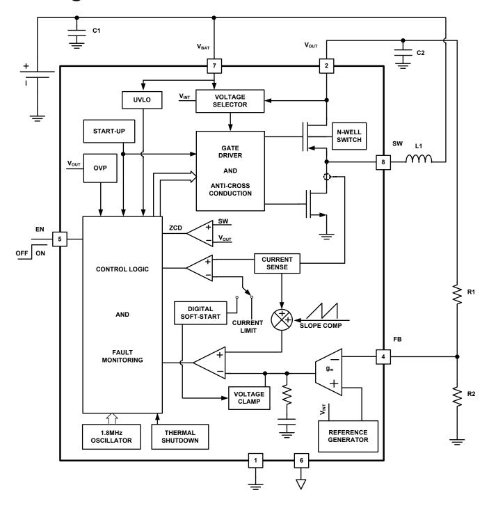
FIGURE 3. BLOCK DIAGRAM
