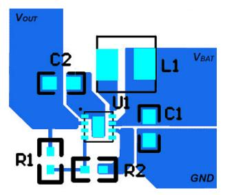
FIGURE 4. RECOMMENDED PCB LAYOUT
