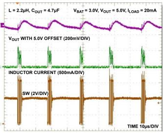
FIGURE 7. PULSE SKIP MODE WAVEFORM
