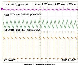
FIGURE 8. PWM WAVEFORM
